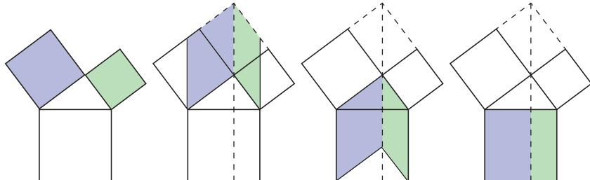
Первое перекашивание состоит в том, что мы делаем одну из сторон вертикальной. Но нужно ещё проверить, что после она становится равной гипотенузе. Можно сделать это следующим образом.
