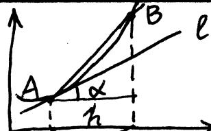
Мгновенная скорость = тангенс угла наклона касательной
